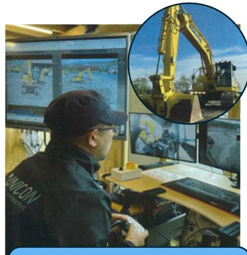
ゲームのコントローラで重機を遠隔操作
